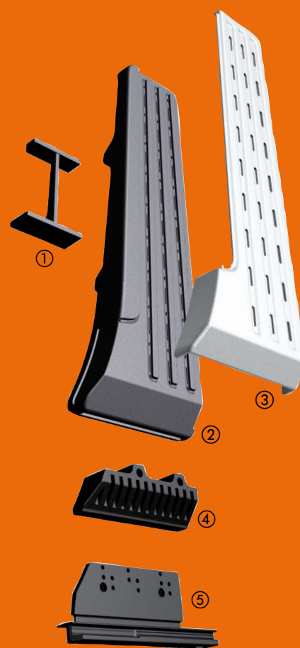
Schematischer Aufbau Gaspedal
